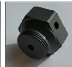
El AICD usa el efecto ciclónico para limitar la producción de fluidos menos viscosos como el agua y gas, mientras mantiene la producción de fluidos más viscosos como el petróleo pesado.
