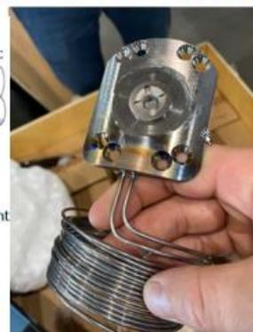
El AICV es una combinación entre las tecnologías de disco e hidrociclón. Fluidos menos viscosos como el agua y gas, pasarán por el espiral recorriendo mayores distancias en comparación con el crudo pesado que pasará directamente por el disco.
